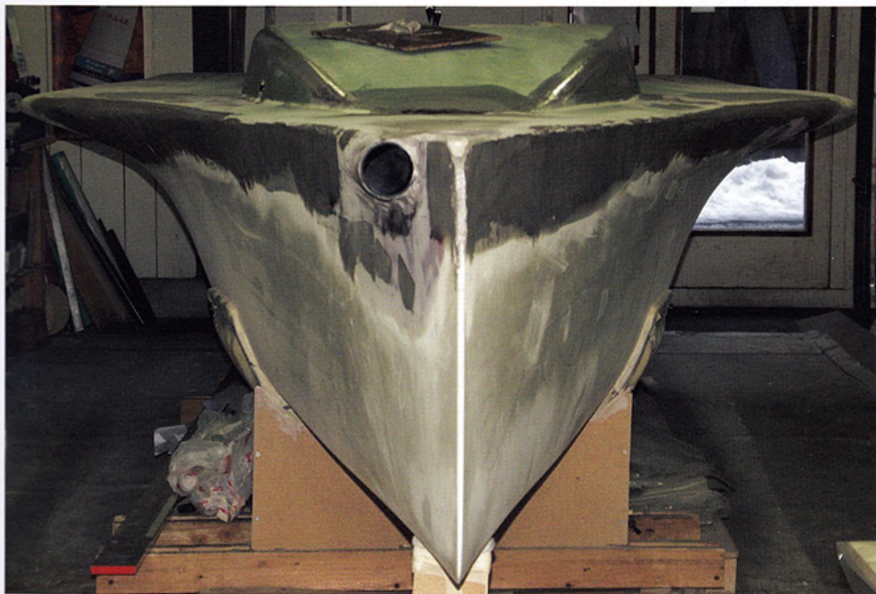
La coque de *Coriace* est en strip-planking de cèdre rouge, renforcée par une structure mousse/verre/époxy. Le mât est en carbone, avec deux barres de flèches poussantes pour la stabilité. L'absence de bastingages facilite la manœuvre. Il est doté d'un bout-dehors pour porter des spis asymétriques.
